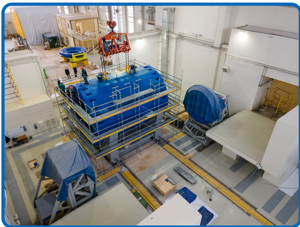
Рис. 2. Магнитопровод собран. Fig. 2. The magnetic circuit is assembled.
