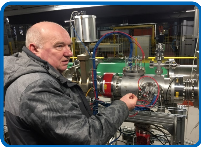
Рис. 3. Ионизационный профилометр в секции инжекции Бустера.
